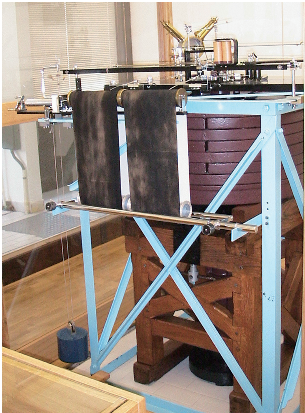
図 3 Wichert 水平動振動型地震計。 正面上部にある回転式の黒い布に地震波が記録されるように作られている。この布は石墨塗布型で、何度も再利用される。
